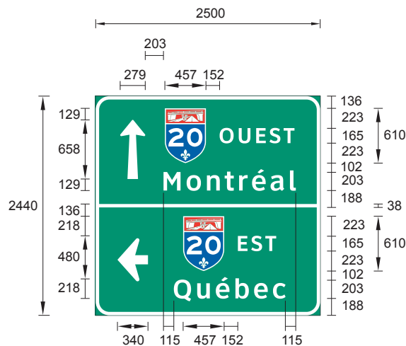
Figure 4.5-2 Exemple de panneau d'accès à l'autoroute (I-90)
