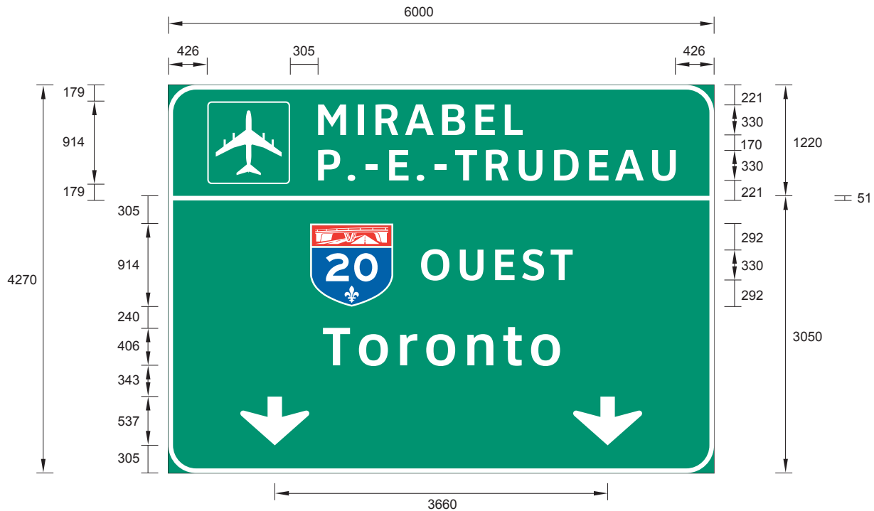
Figure 4.8–1 Exemple de panneau comprenant une section de signalisation d'un aéroport
