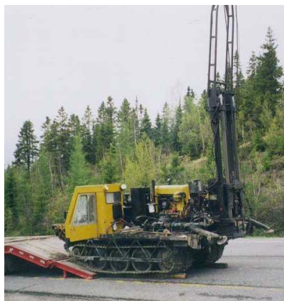
Figure 2 : Exemple d'une foreuse spécifique à la reconnaissance de sols
